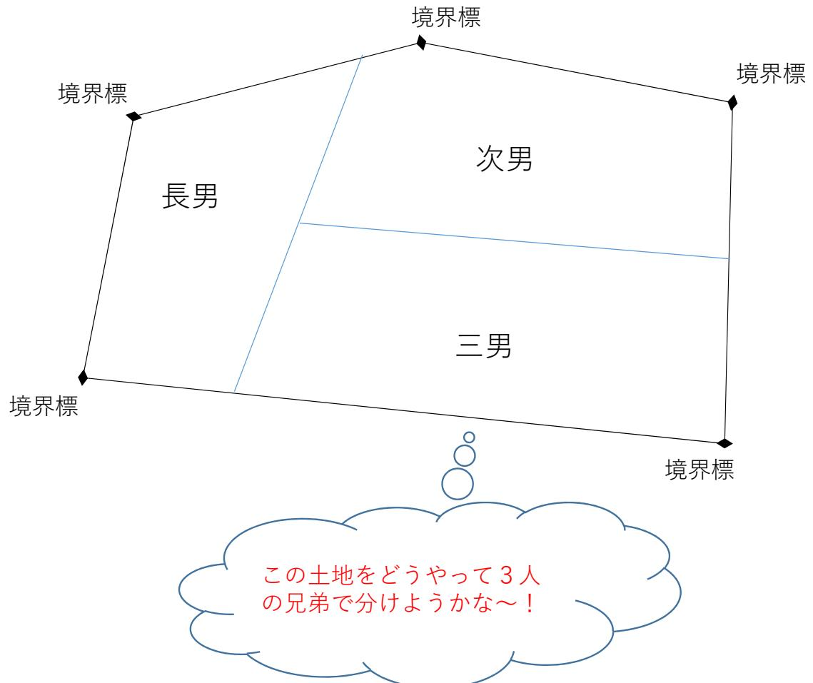
分割測量は一定の面積にするために、新点の座標値を求める必要がある。連立方程式で計算する方法と、三角形に分解する等いろいろな方法がある。
