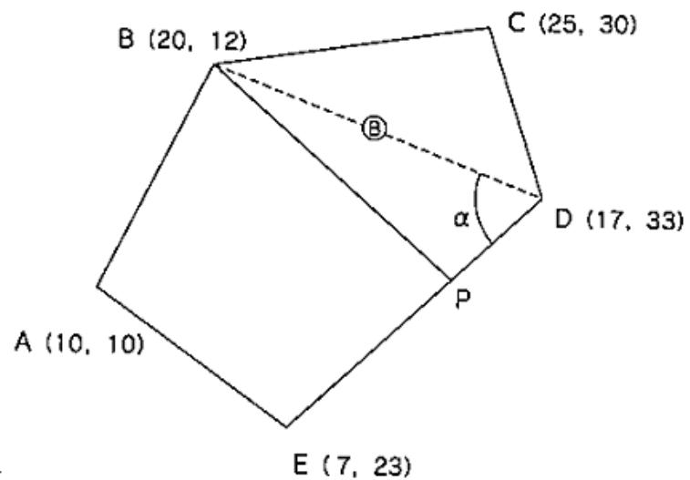
[各座標値からDBの距離、21.213m、方向角 $278^{\circ} 7' 48''$ 、DEの方向角 $225^{\circ} 0' 0''$ であるから、
